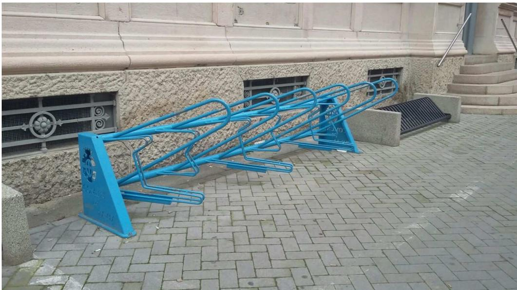
*Esistono vari tipi di reggibici, per contrastare il furto si necessitano quelli con staffa di aggancio del telaio cosicché si possa legare contemporaneamente sia la ruota frontale che il telaio.*
