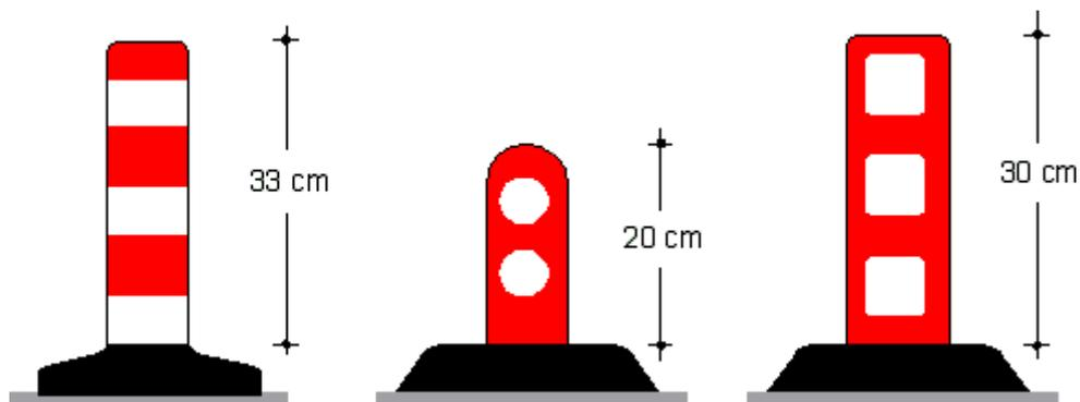
Gli elementi prefabbricati per salvagenti pedonali e **delimitatori di corsia** possono essere realizzati in calcestruzzo, costituiti da sezioni componibili mediante appositi incastrici. Essi devono essere impiegati solo nelle zone urbane per la creazione di isole pedonali di rifugio ovvero piattaforme di carico.
